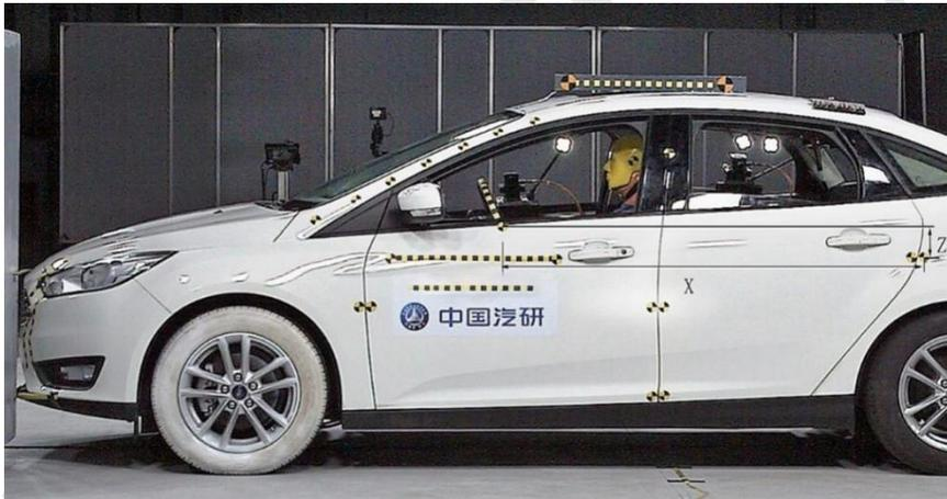
图 I.1 后车门锁扣标识到方向盘中心标识之间距离的测量
