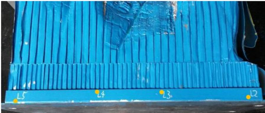
图 C.8 壁障变形测量还原点示意
