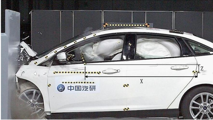
图 1.3 标记车门上的方向盘中心（碰撞中）
