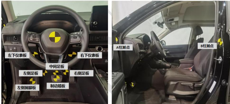
图 C.6 车辆侵入量测量位置示意
