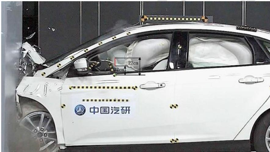
图 1.4 方向盘中心到侧面头部保护安全气囊前端的距离测量
