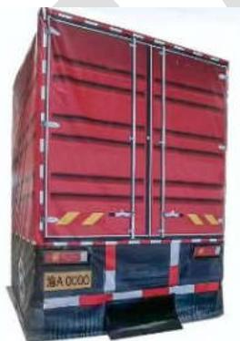
图 6 卡车柔性目标物外观示意图
