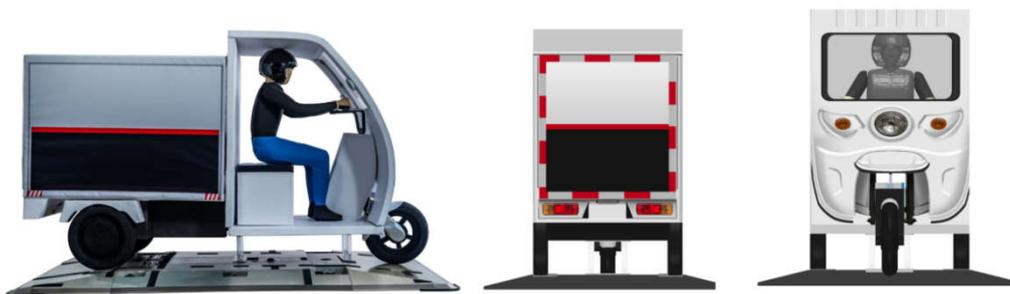
图 7 快递三轮车柔性目标物外观示意图
