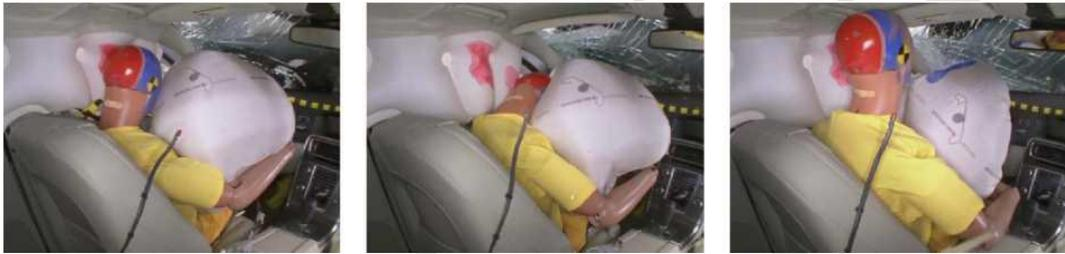
注：碰撞过程中，假人头部滑入正面安全气囊和侧面头部保护安全气囊之间的间隙之前短暂地受到了正面安全气囊的作用力（正面安全气囊较窄，且没有其它措施防止头部与安全气囊前方的硬接触）。
