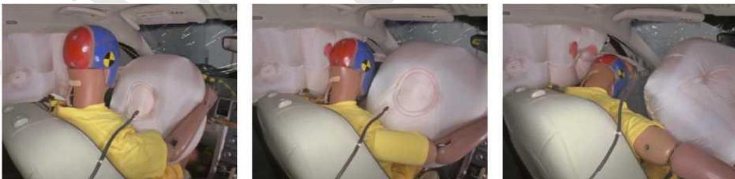
注：碰撞过程中，假人头部完全没有接触正面安全气囊，且没有其它措施防止头部与安全气囊前方的硬接触。
