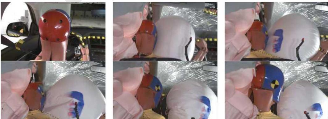
注：碰撞过程中，假人头部受到了正面安全气囊的作用力，随后直接滑到左侧，而且没有其它措施防止头部与安全气囊前方的硬接触。
