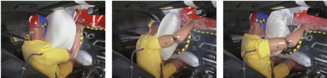
注：碰撞过程中，假人头部受到了安全气囊的作用力，但随后绕气囊旋转滑到了左侧，而且没有其它措施防止头部与安全气囊前方的硬接触。
