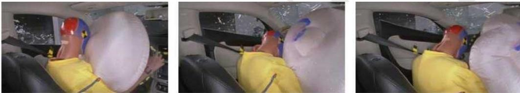
注：碰撞过程中，假人头部在滑动到左侧之前几乎没有接触到正面安全气囊，且没有其它措施防止头部与安全气囊前方的硬接触。
