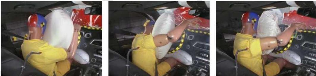
注：碰撞过程中，假人头部受到了安全气囊的作用力，但随后绕气囊旋转滑到了左侧，而且没有其它措施防止头部与安全气囊前方的硬接触。
